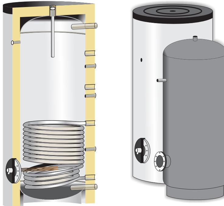
S1 = unterer Wärmetauscher
